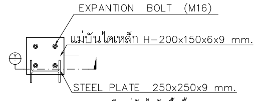
5 DETAIL (แบบขยายการยึดแม่บันไดกับพื้นชั้นบน) SCALE A3 1:1:25
