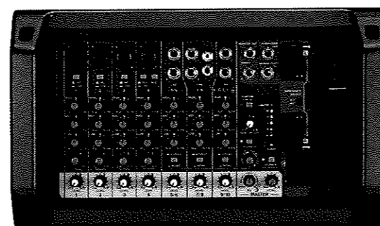
เครื่องผสมสัญญาณเสียงแบบมีเครื่องขยายเสียงในตัว
